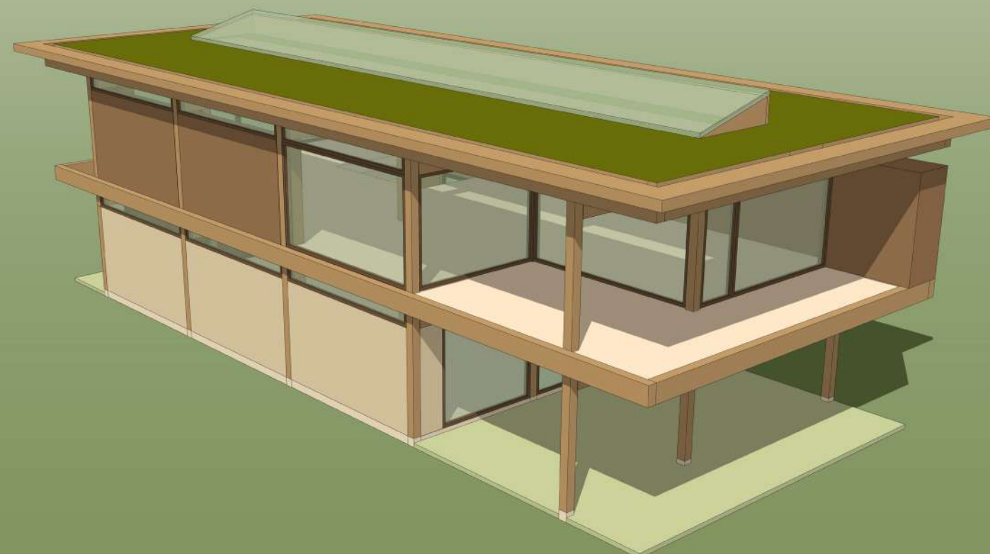
7. SEDUMDAK MET DAKLICHT/ZONNEPANELEN EN BESTRATING TERRASSEN
