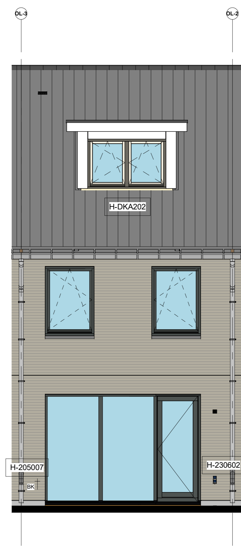
H-205007 Buitenkraan in achtergevel H-DKA202 Dakkapel achtergevel, 1800mm (binnenwerks) met overstek H-230602 Spatwaterdichte wandcontactdoos achtergevel
